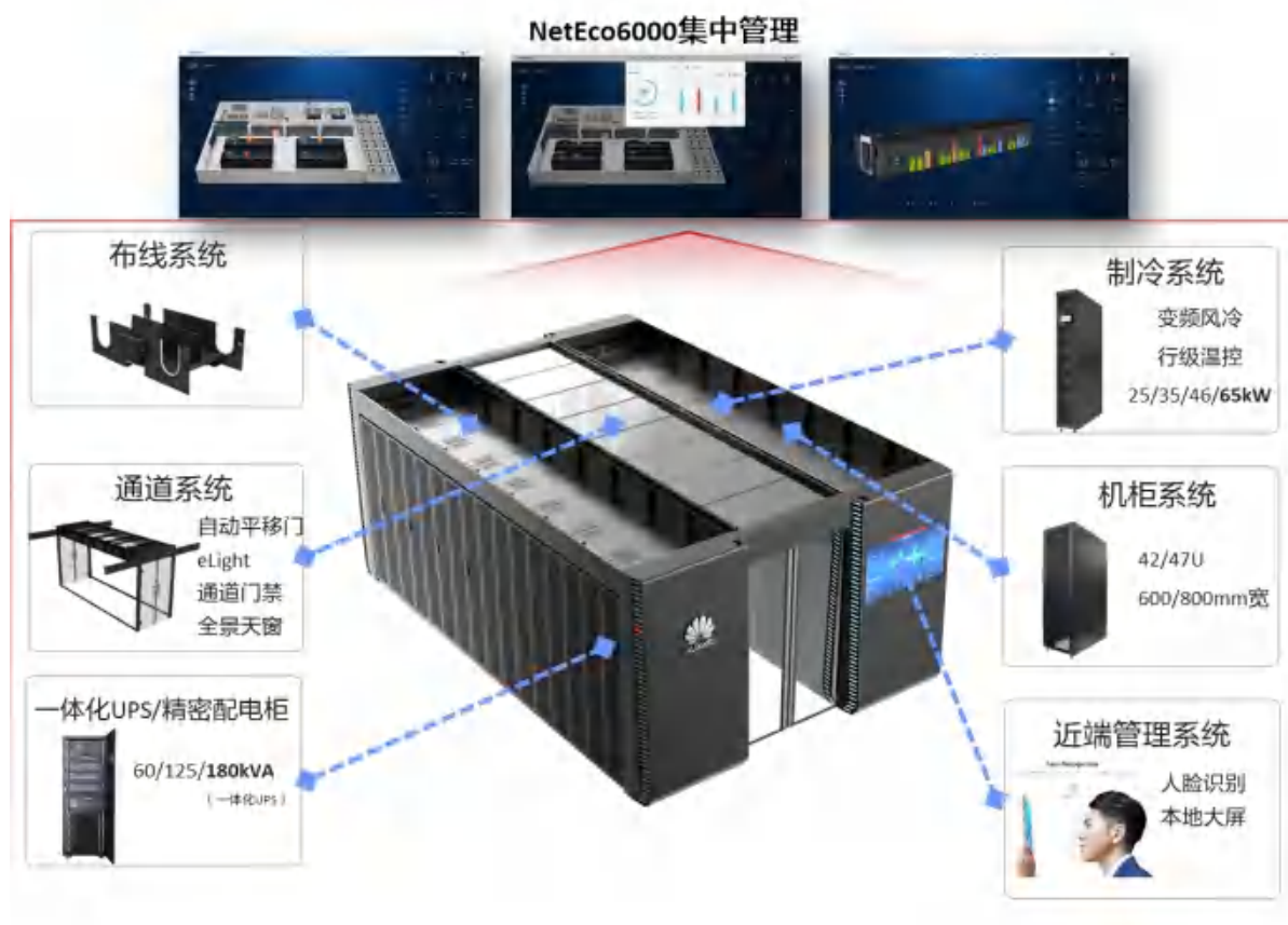
智能微模块技术系统架构图
