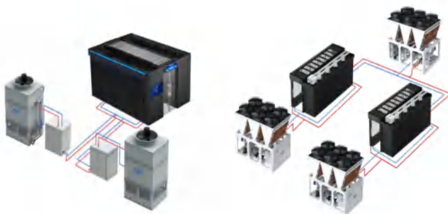
基于智算高密场景悬浮多联热管近端制冷技术原理图
