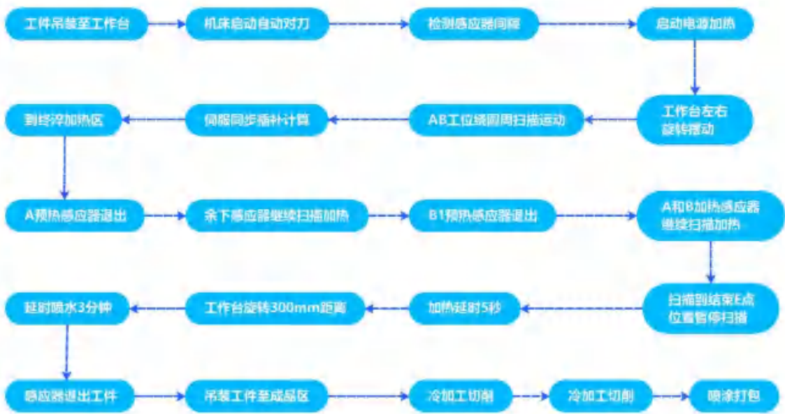
大型海装风电主轴轴承无软带感应淬火技术工艺流程图
