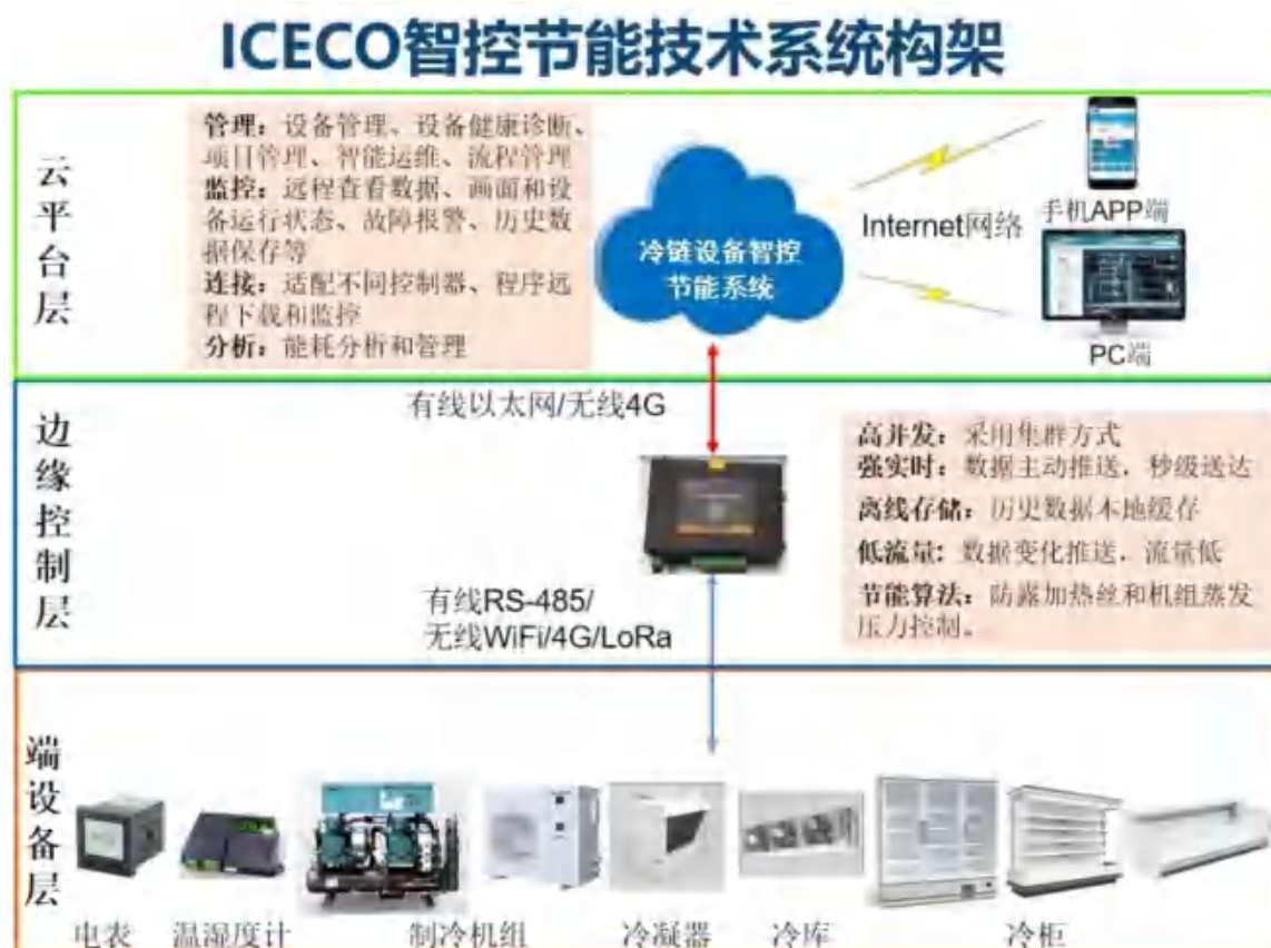
冷链设备智控节能系统架构示意图
