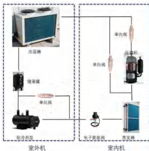
双回路变频式氟泵技术工作原理图
