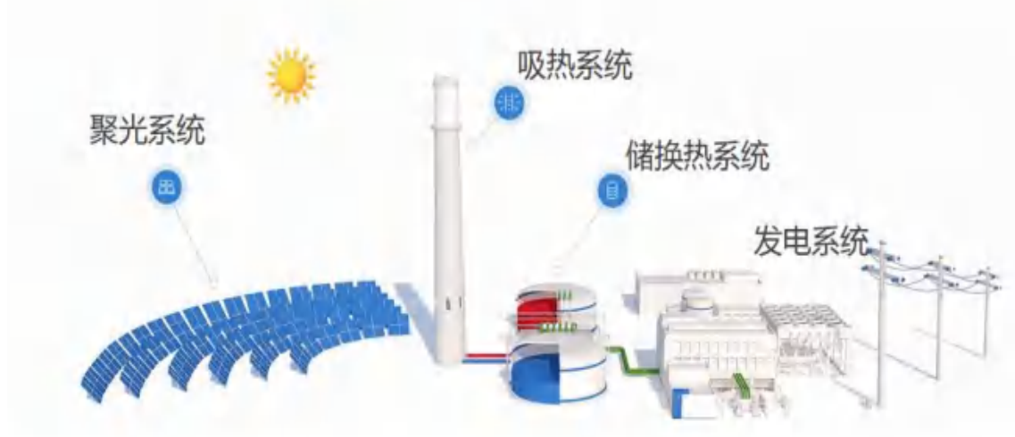
塔式熔盐储能光热发电技术原理图
