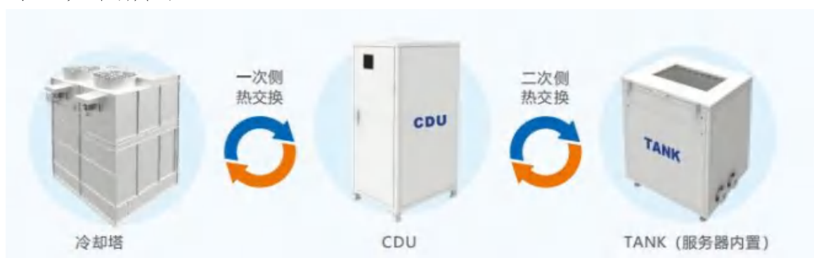
智算中心低能耗浸没液冷技术工作原理图
