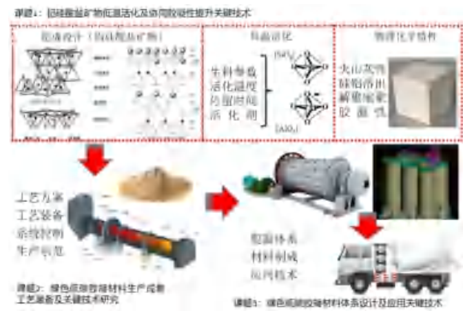
水泥用活化铝硅酸盐胶凝材料制备关键技术路线图
