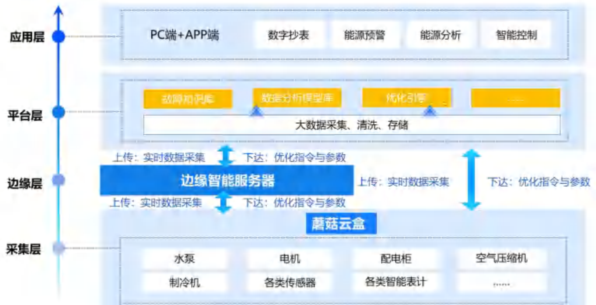
基于人工智能大模型的公辅车间数字化能效协同调控技术原理图
