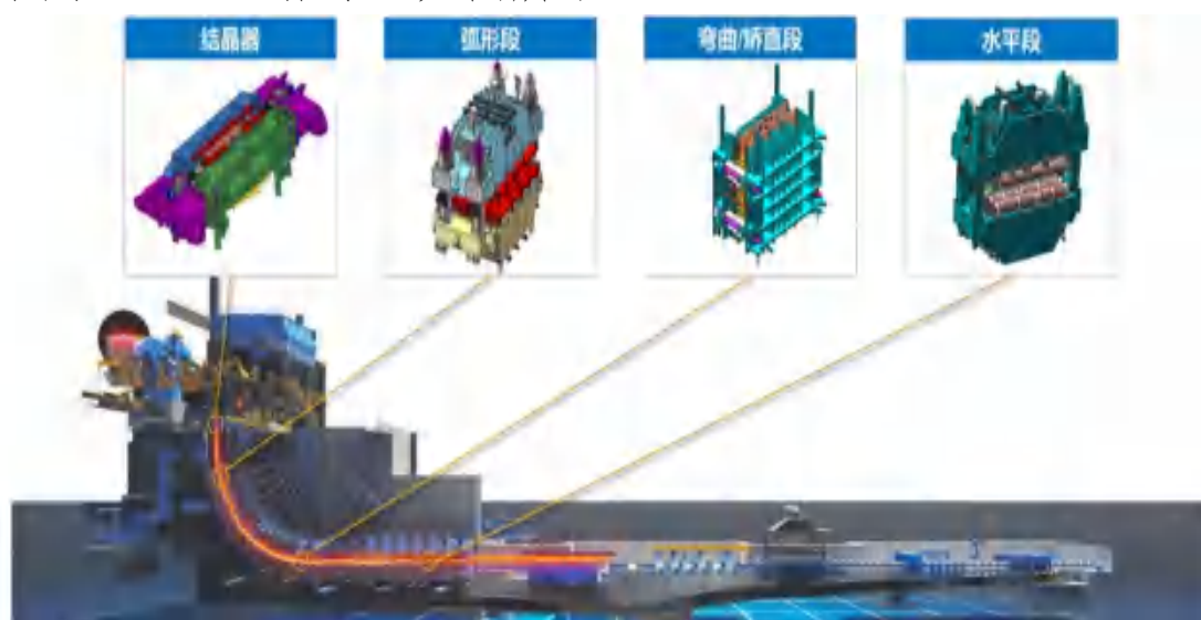
直弧型特厚板连铸技术工作原理图
